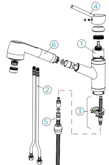
**Hinweis:** Diese Explosionszeichnung bildet die Hochdruck-Armatur mit deren Ersatzteilen ab. Für die Niederdruck-Armatur gelten andere Ersatzteilnummern.
